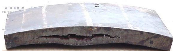
Расслоение в основном металле
