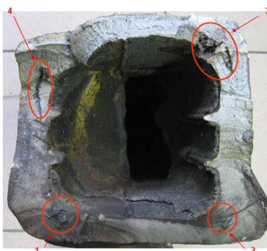
Внутренние дефекты в боковой раме 1 – усадочная рыхлота размером 8x11 мм; 2 – усадочные рыхлоты размером 11x5 мм; 3 – усадочная пористость размером 50x11 мм; 4 – газоусадочная рыхлота размером 27x4,5 мм.
