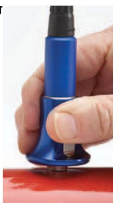
Измерение толщины через покрытие.
