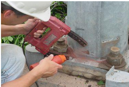
Проведение МТ контроля электромагнитом с использованием бурого сухого порошка (слева) и магнитной суспензии (справа)
