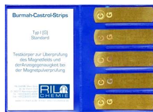
Магнитные индикаторные полоски для проверки достаточности величины намагничивающего поля, также известные как полоски "Burmah-Castrol-Strip", представляют собой полоски ферромагнитного материала с высокой магнитной проницаемостью и изготовленными в нём химическим способом прорезями различной ширины
