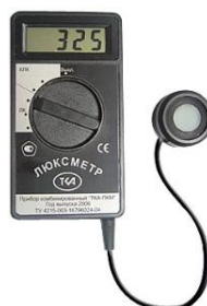
Измерение интенсивности освещённости контролируемой поверхности производится с помощью люксметров.
