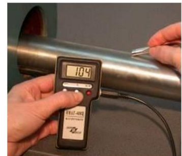
Измерение тангенциальной составляющей напряжённости магнитного поля на поверхности намагниченной детали
