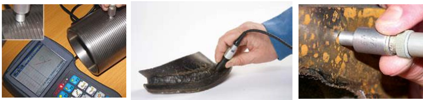
Проведение вихретокового контроля по грубой поверхности
